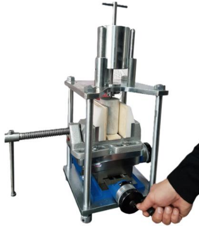
Şekil 43. Cerchar aşınma deneyi aleti ve uygulaması
