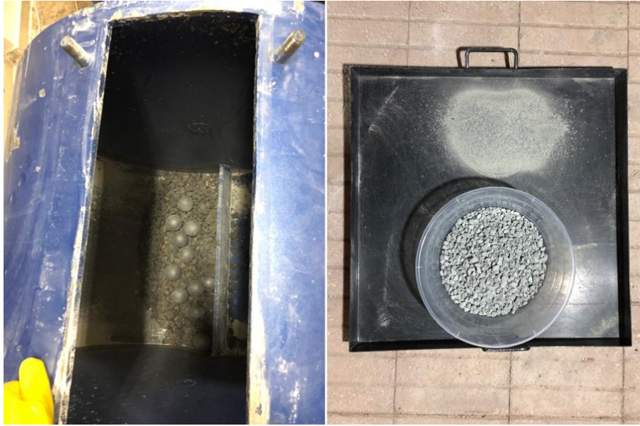
Şekil 40. Los Angeles deney aleti ve uygulaması
