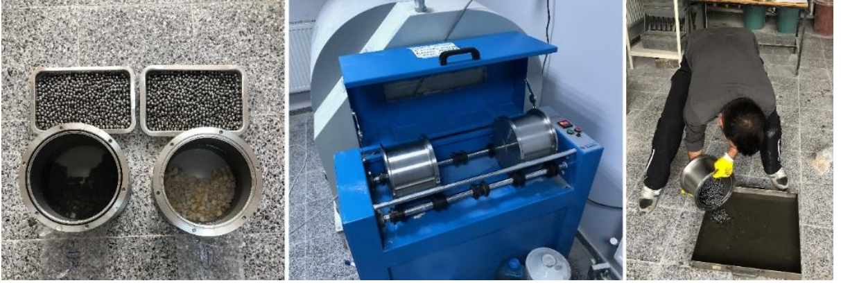
Şekil 41. Mikro-Deval deneyinin uygulanışı
