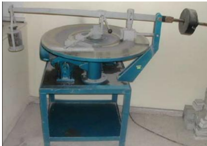
Şekil 42. Böhme aşınma deneyi alet ve uygulanışı
