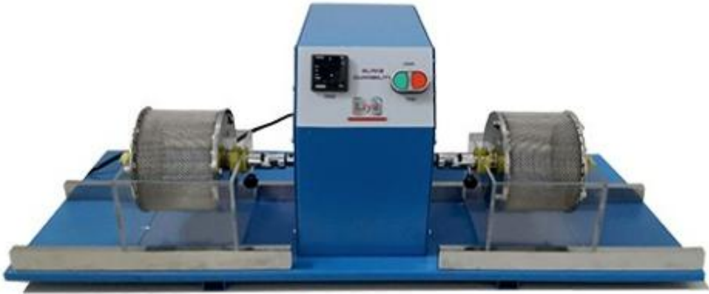
Şekil 46. Suda dağılmaya karşı dayanıklılık deney aleti
